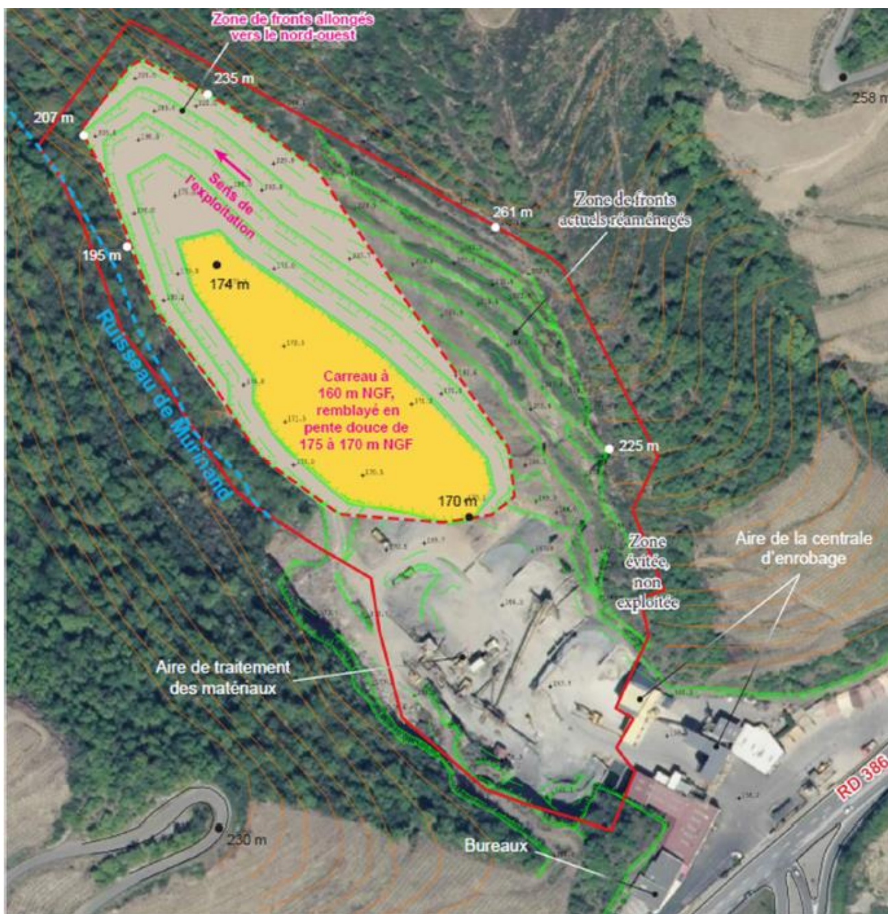
Plan de la carrière et de remise en état issu de l'étude d'impact
